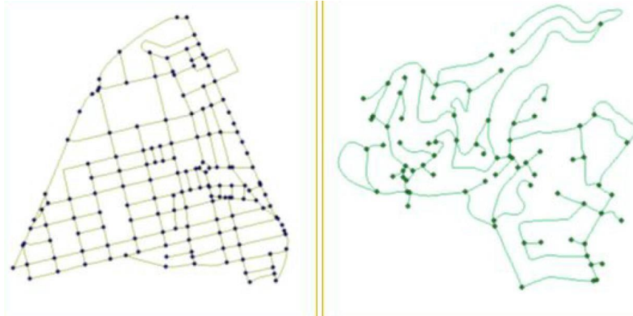
Figura 25. Tipos de red vial: en malla a la izquierda y jerárquica a la derecha. Elaboración propia.
