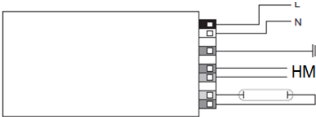
Ilustración 10: Conexión de un equipo para doble nivel. Fuente propia
