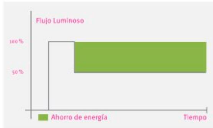
Ilustración 61: Ahorro energético debido a los escalones de regulación. Fuente: www.schreder.com
