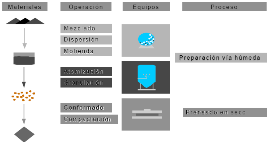
Figura 13. Proceso de fabricación de baldosas cerámicas. Fuente (ASCER 2009a).
