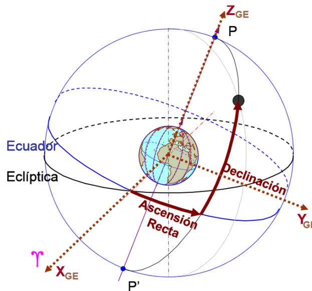
**Figura 5:** El sistema de referencia Geocéntrico-Ecuatorial: Coordenadas cartesianas y angulares
