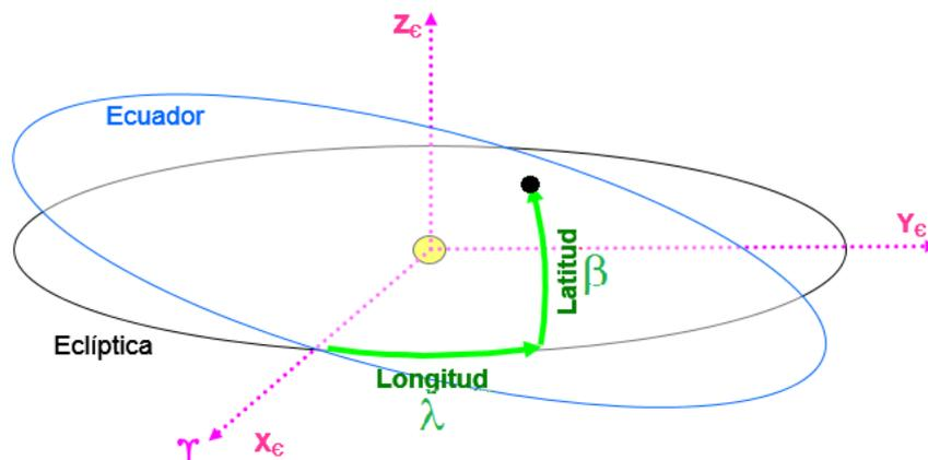
**Figura 4:** El sistema de referencia Heliocéntrico-Eclíptico: Coordenadas cartesianas y angulares
