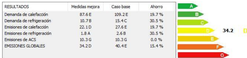
Figura 79: Medida de mejora, aislamiento bajo cubierta. Año 2020.
