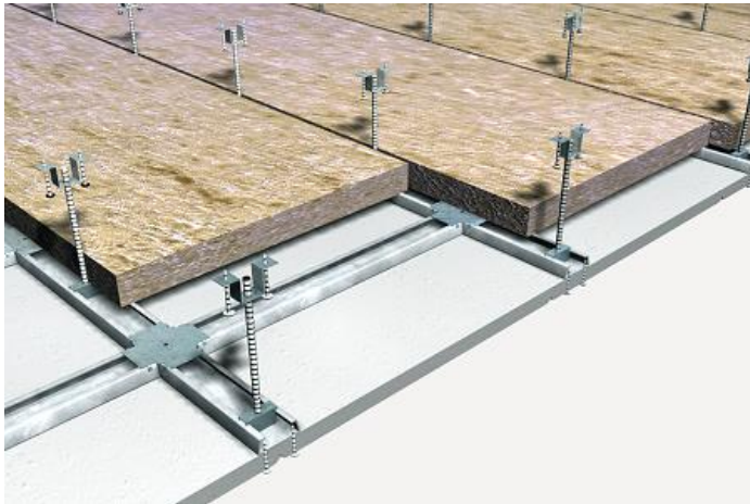
Figura 78: Falso techo con aislamiento superior. Año 2020.
