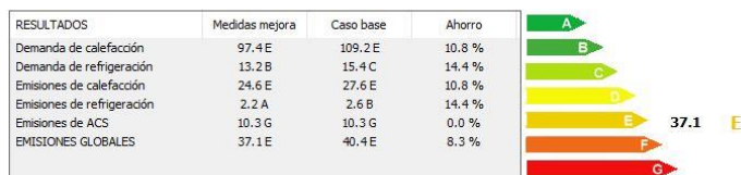
Figura 73: Medida de mejora, fachada SATE. Año 2020. Fuente propia
