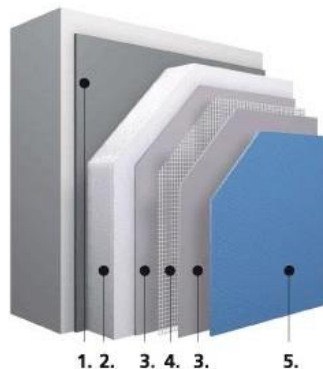
Figura 74: Sistema SATE. Año 2020. Fuente Verticalia
