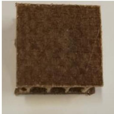
Figura III. 44. Probeta sometida a compresión.
