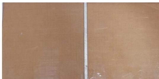
Figura III. 29. Placas de acero recubiertas con film de teflón resistente al calor.
