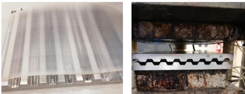
Figura III. 20. Prueba de fabricación de núcleo de panal de abeja con film de 250  $\mu\text{m}$  en termocompresora.
