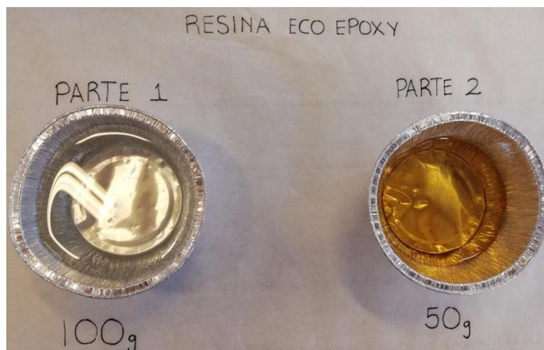
Figura III. 36. Tara de recipientes para resina y endurecedor. Parte 1: resina (100g). Parte 2: endurecedor (50g).
