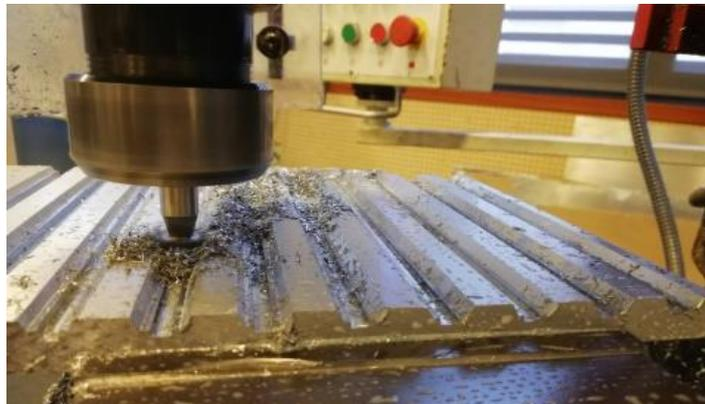
Figura III. 12 . Cortes realizados por la herramienta hexagonal en pieza de aluminio superior e inferior.
