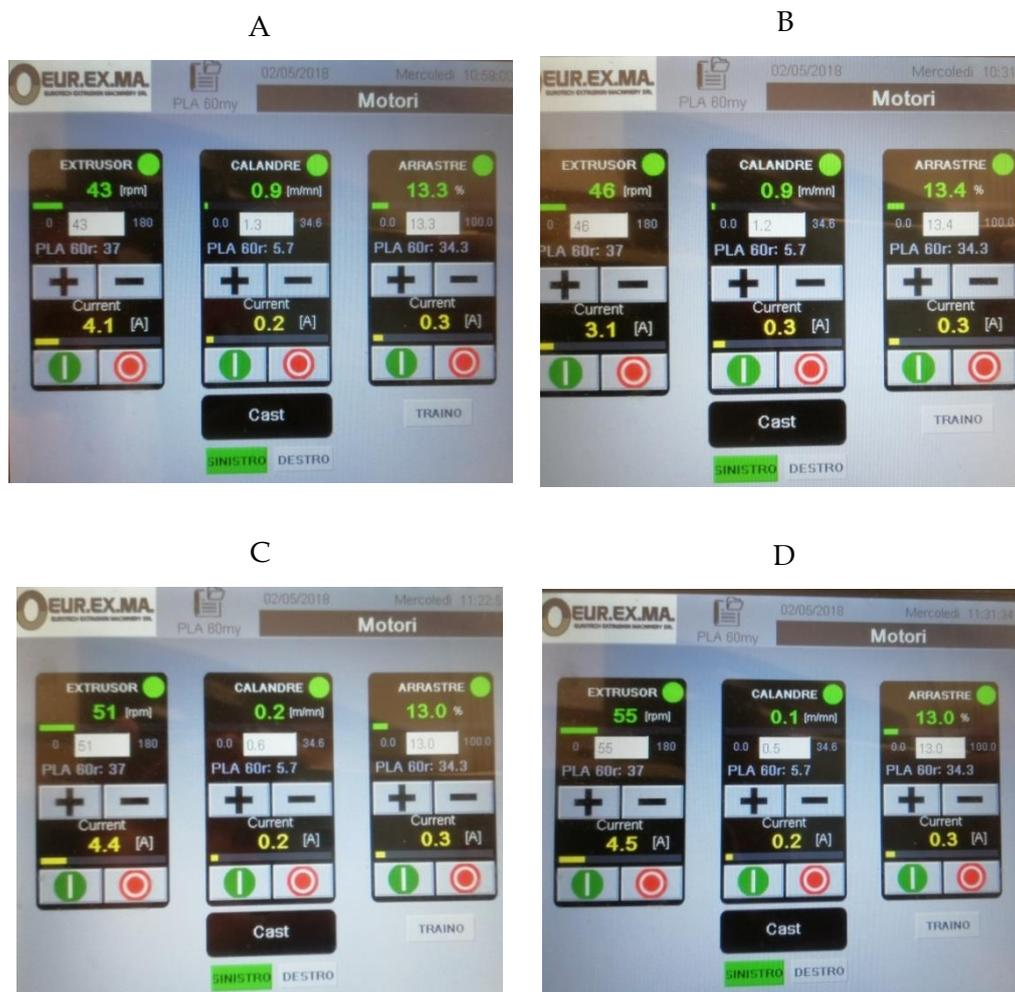
Figura III. 16. Parámetros de funcionamiento de maquina extrusora. EUROTECH EXTRUSION MACHINERY SRL. A) 50  $\mu\text{m}$ , B) 100  $\mu\text{m}$ , C) 250  $\mu\text{m}$ , D) 500  $\mu\text{m}$ .
