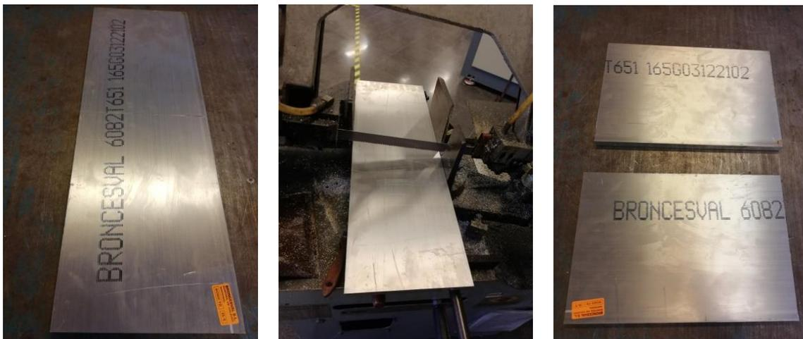
Figura III. 9. Proceso de corte de material de aluminio.
