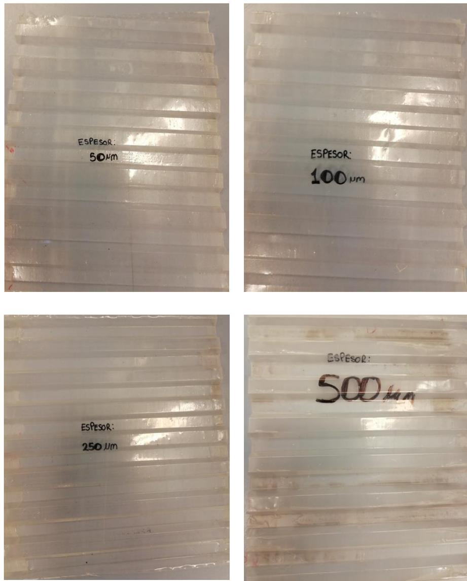
Figura III. 21. Moldeo por temperatura y presión con films de PLA de 50  $\mu\text{m}$ , 100  $\mu\text{m}$ , 250  $\mu\text{m}$  y 500  $\mu\text{m}$ .
