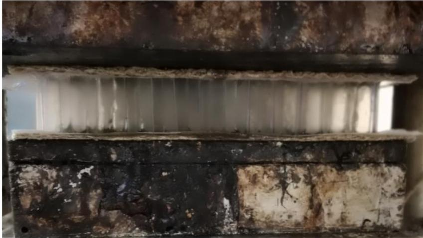
Figura III. 38. Sándwiches sometidos a presión en termocompresora para curado de resina.
