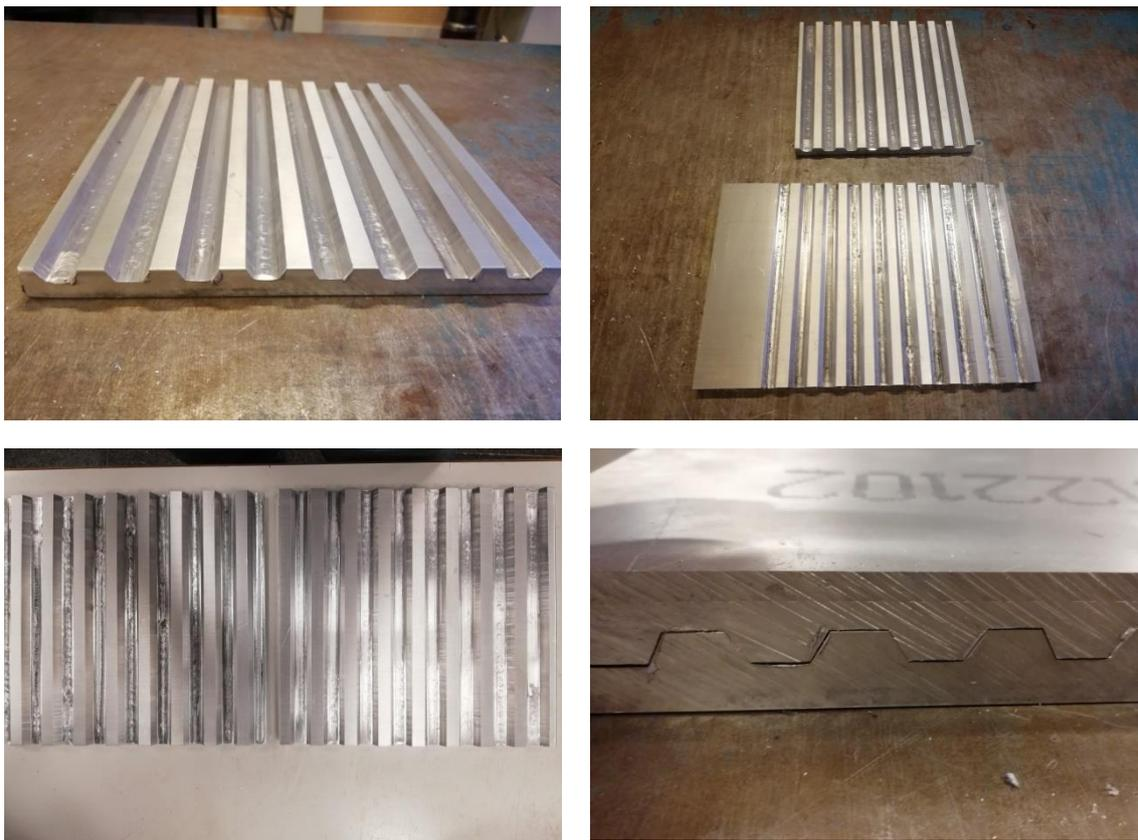
Figura III. 13. Molde de panal de abeja de 20 x 20 cm, parte superior e inferior cortada y fresada.
