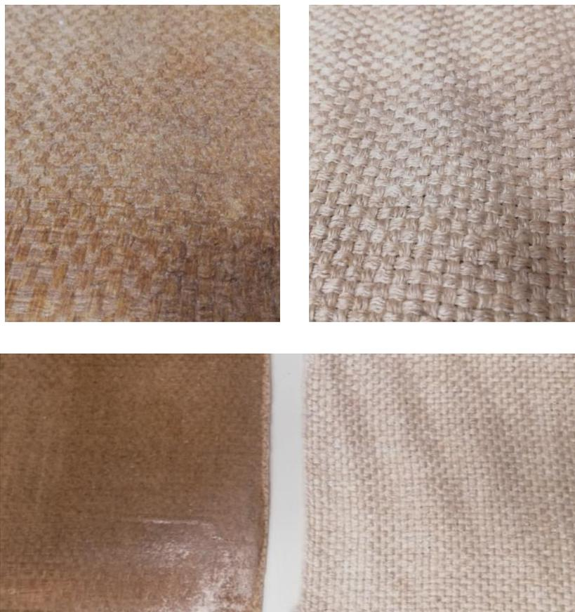
Figura III. 32. Lamias de Lino + PLA antes y después de ser sometidas a temperatura y presión.
