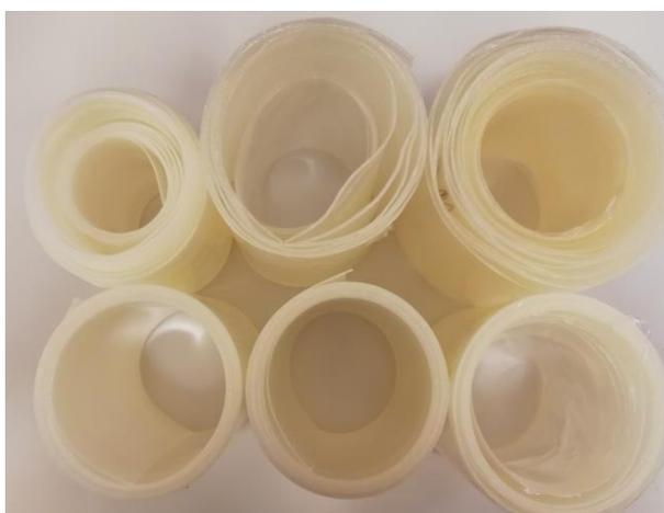
Figura III. 17. Films de PLA de 50  $\mu\text{m}$ , 100  $\mu\text{m}$ , 250  $\mu\text{m}$ , 500  $\mu\text{m}$ .
