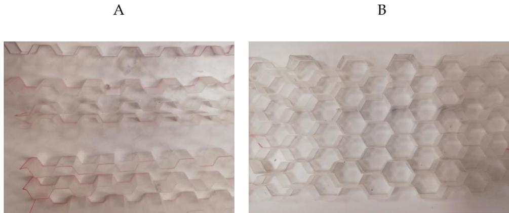
Figura III. 24. A) Film de PLA de 1 cm después de conformado. B) Núcleo de PLA de 1 cm en forma de panal de abeja.
