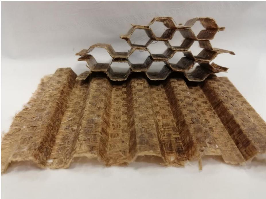
Figura IV. 7. Laminas y núcleos en forma de panal de abeja elaborados de lino + PLA por medio de termo conformación.
