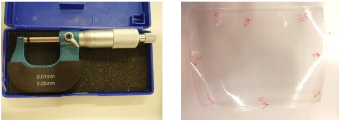
Figura III. 18. Inspección de espesor en film generado en maquina extrusora mediante el uso de micrómetro.
