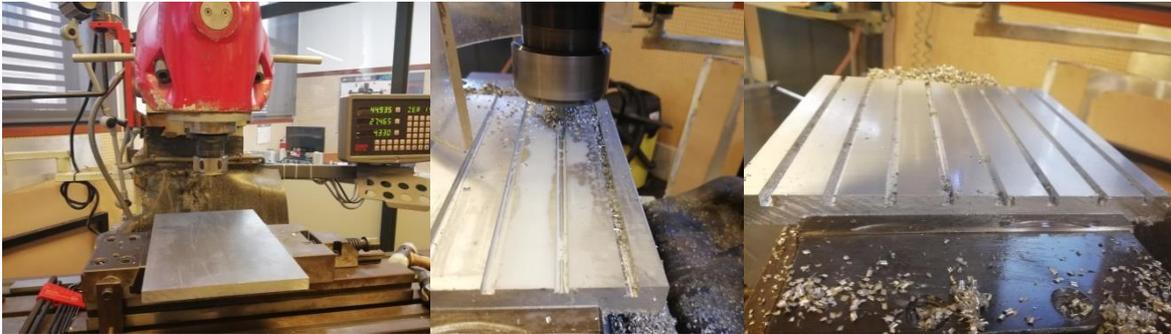
Figura III. 11. Montaje y modificación previa de pieza de aluminio en equipo fresadora con herramienta de corte de 5 mm.
