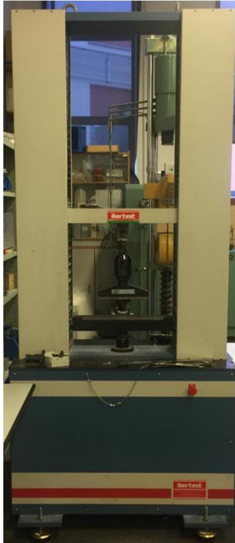
Figura III. 40. Máquina universal de ensayo de tracción IBERTEST.
