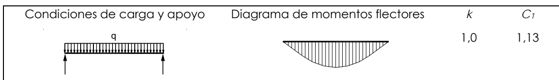
Figura 3. Coeficiente C_1 para soportes biarticulados en los dos planos
