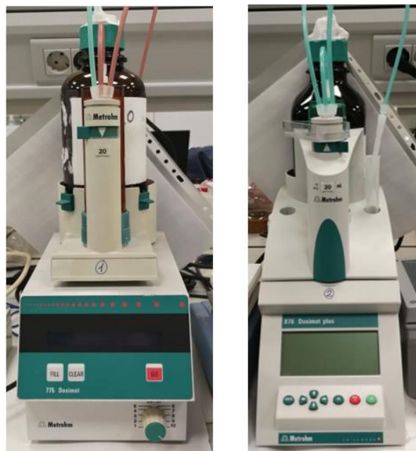
Figura 9: Dosimat 775 (izquierda) y Dosimat Plus 805 (derecha).
