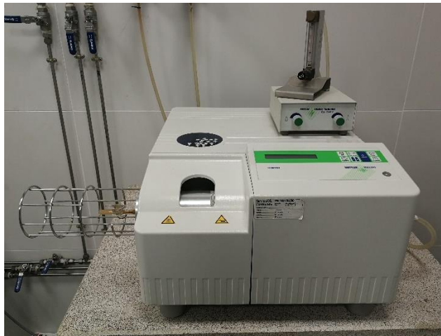
Figura 13: Equipo de termogravimetría.
