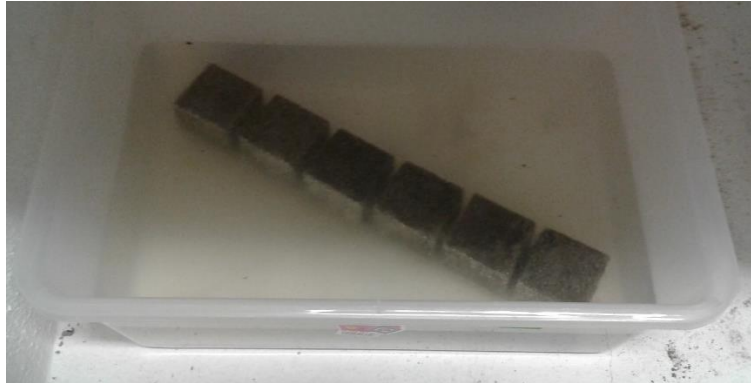
Figura 19: Probetas cúbicas inmersas en solución ácida pH inicial 0.
