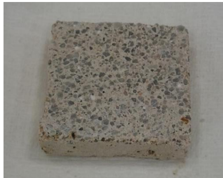
Figura 17: Sección de probeta utilizada para el ensayo de pérdida de masa a pH 2.
