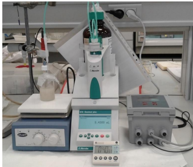
Figura 16: Montaje del equipo para el ensayo de ANC.
