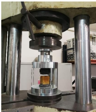
Figura 15: Equipo para ensayo de resistencia a compresión.
