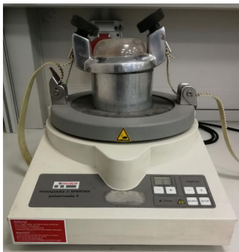
Figura 8: Micromolino vibratorio FRITSCH.
