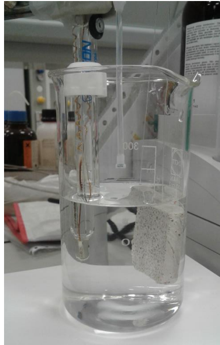
Figura 18: Montaje utilizado para el ensayo de pérdida de masa.
