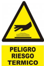
Ilustración 4. Señalización peligro riesgo térmico
