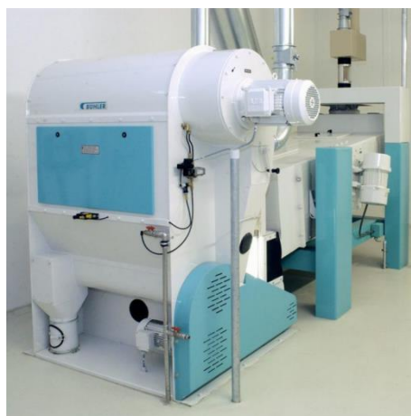
Figura 3-8 Canal aspiración con recirculación de aire.
