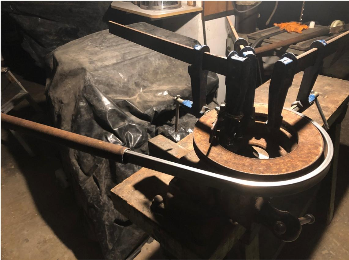
**Figura 27.** Dobladora compuesta por un gato de banco, un disco de rueda de vehículo y gatos.
