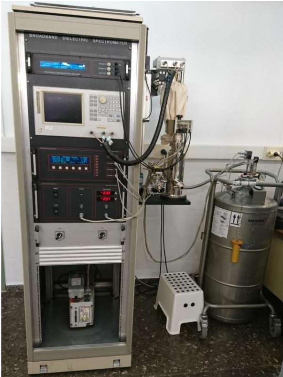
Figura 16. Equipo de espectrómetro dieléctrico de banda ancha (BDS) Novocontrol utilizado.
