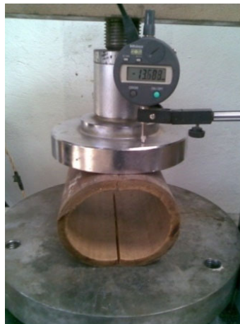
Fig. 4.11. Esquema general del ensayo de compresión perpendicular a las fibras.
