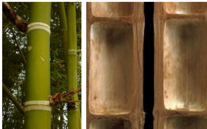
Fig. 2.3. Detalle de bandas anulares y entrenudos en sección completa (izquierda) y corte transversal (derecha).
