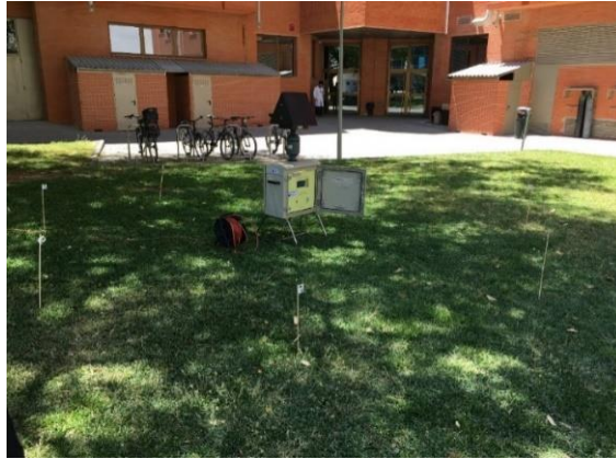
Figura 4 Captador de volátiles en las pruebas de exterior.
