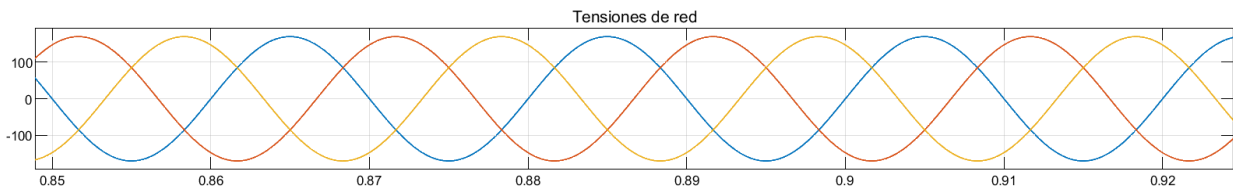
Figura 4-1 Tensiones de alimentación senoidal y equilibradas
