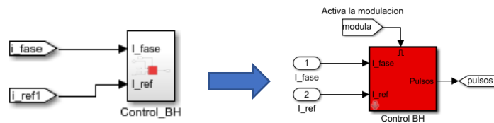
Figura 3-3 Bloque de control de corriente del convertidor
