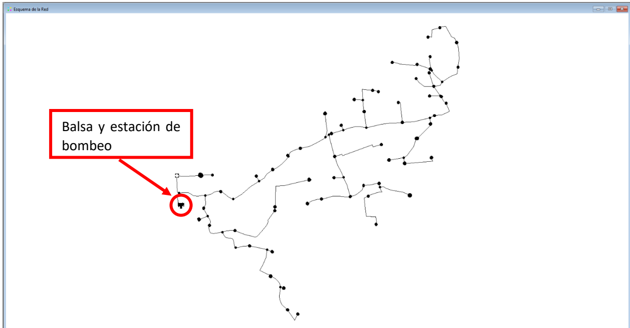
Figura 36. Red de riego modelada en Epanet
