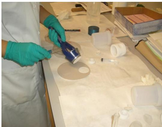
**Figura 3-11 Obtención de muestras de 47 mm de diámetro a partir de filtros de 150 mm de diámetro.**
