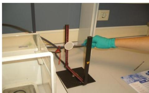
**Figura 3-5** Balanza para determinar el peso de las muestras y sistema de ionización del aire para evitar problemas de electricidad estática
