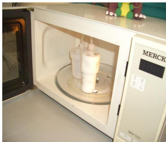
**Figura 3-10 Digestión utilizando horno microondas**
