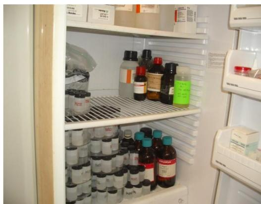
**Figura 3-6 Almacenamiento de muestras líquidas obtenidas por digestión ácida de los filtros**
