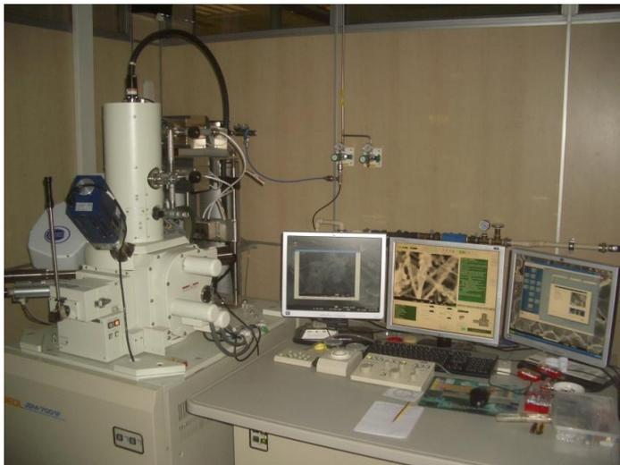
Figura 3-14 Microscopio electrónico utilizado JEOL 7001F (UJI)
