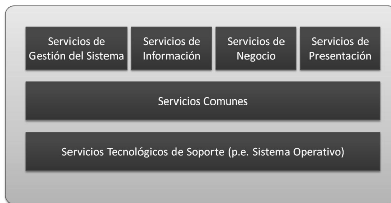
Figura 4-5: Infraestructura de Integración CIMOSA
