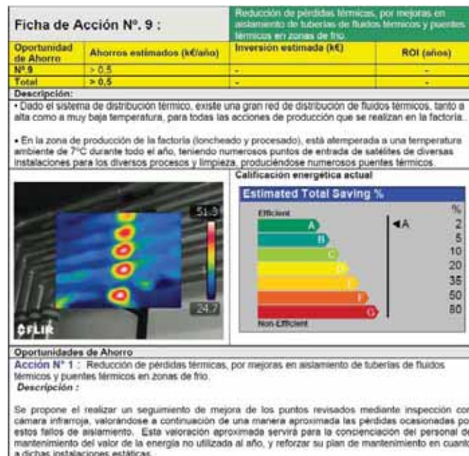
Figura 9: Ejemplo de ficha de acción de eficiencia energética de baja intensidad, para los procesos de conocimiento de la organización de mantenimiento. Fuente: Elaboración propia.
