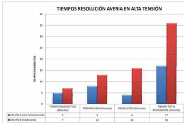
Gráfica 6. Tiempos de resolución de avería por rearmado celdas de alta tensión. Fuente: Elaboración propia.
