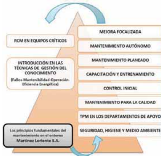
Figura 6. Principios de mantenimiento en las factorías de Martínez Loriente S.A. Fuente: Elaboración propia.
