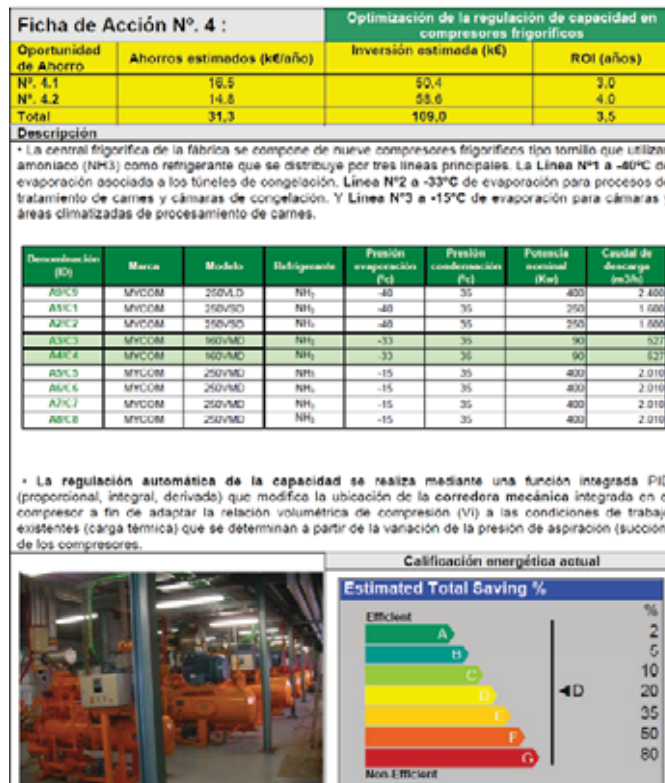
Figura 10: Ejemplo de ficha de acción de eficiencia energética de baja intensidad, para los procesos de conocimiento de la organización de mantenimiento. Fuente: Elaboración propia.
