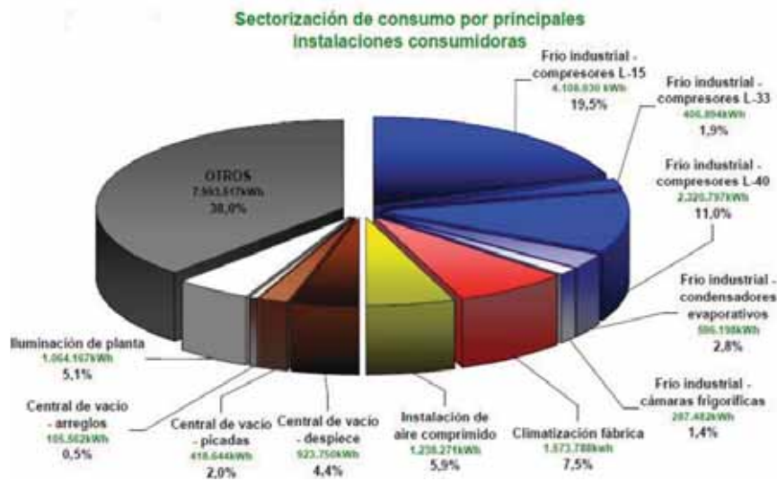
Gráfica 3. Sectorización y cuantificación del consumo energético, como base para el comienzo de la eficiencia energética. Fuente: Elaboración propia.
