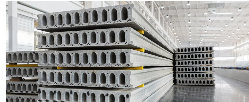
Figura 60. Acopio de placas alveolares.
