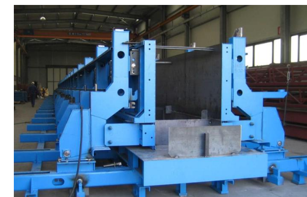
Figura 54. Molde para fabricación de vigas.
