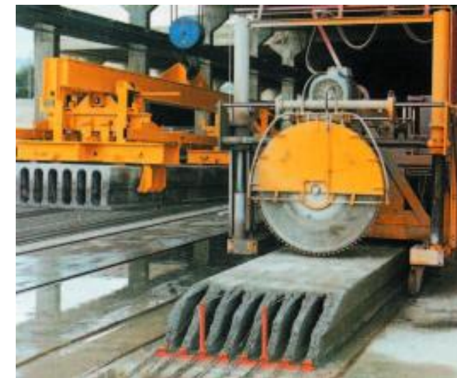
Figura 49. Corte de placas alveolares.
