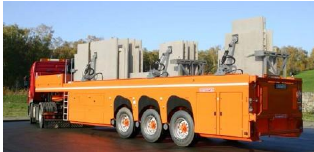
Figura 64. Vehículo empleado en el transporte de elementos industrializados.
