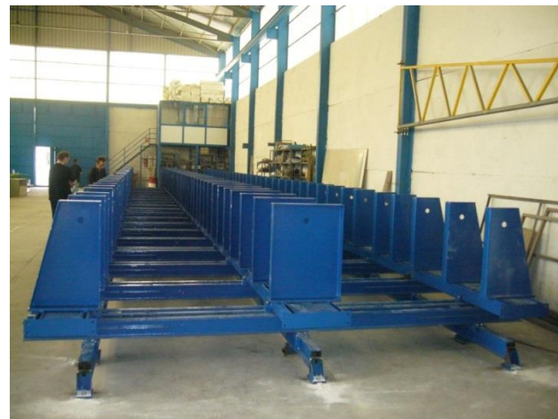
Figura 51. Molde para fabricación de pilares 1.
