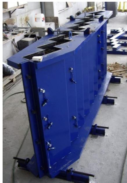
Figura 56. Molde vertical de escalera.
