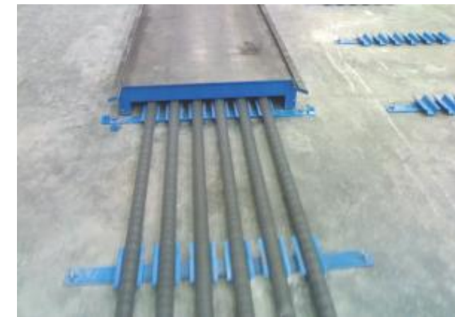
Figura 57. Sistema de tubos para tratamiento térmico.
