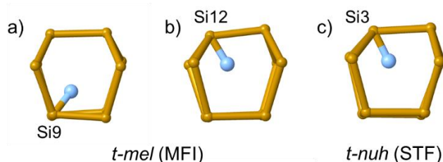
Figura 5. 40. Subunidades estructurales (optimizadas utilizando VASP) que contienen el ^{19}\text{F} de las zeolitas a-b) MFI y c) STF. Los átomos azules y amarillos representan al ^{19}\text{F} y ^{29}\text{Si} respectivamente, los átomos de oxígeno se han omitido para una mejor visualización
