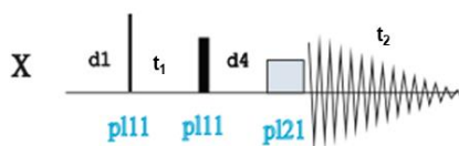
Figura 3. 19. Secuencia de pulso del experimento MQ-MAS.
