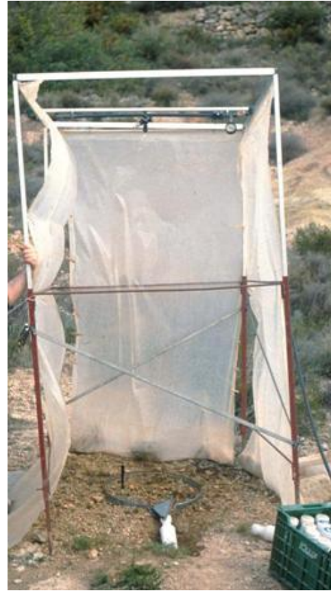
Figura 1. a) Simulador de tipo goteador y b) Simulador de boquilla
