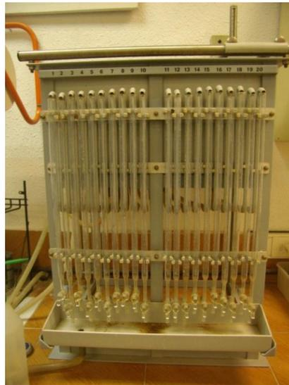
Figura 1.- Permeámetro de laboratorio de 24 muestras
