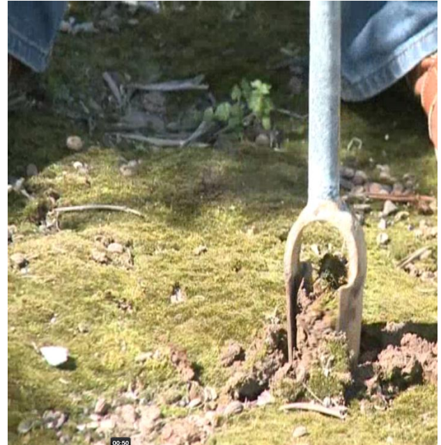
Figura 3.- Barrena tipo holandés o de hoja abierta
