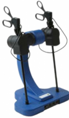
Figura 2.2: Sistema de tracking mecánico Virtual Laparoscopic Interface .
