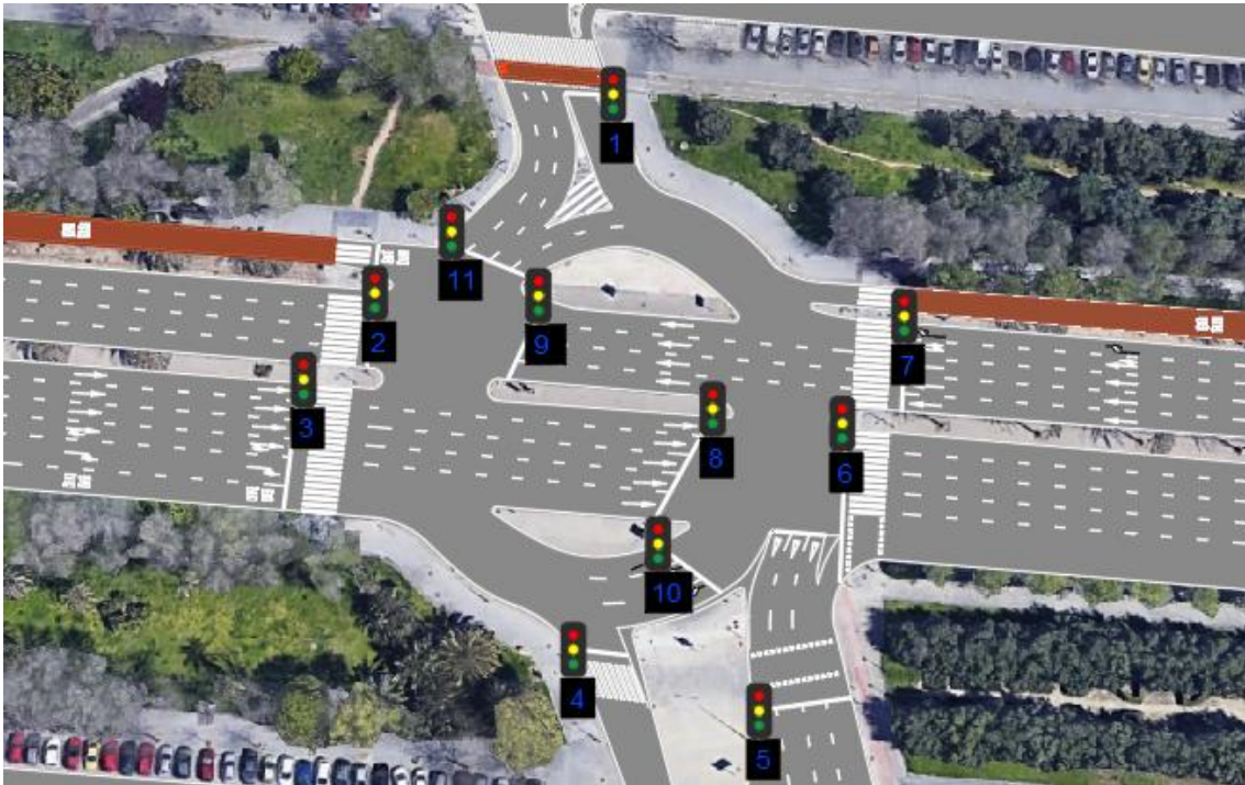
Ilustración 42 - Localización semáforos Intersección de estudio, F.P.
