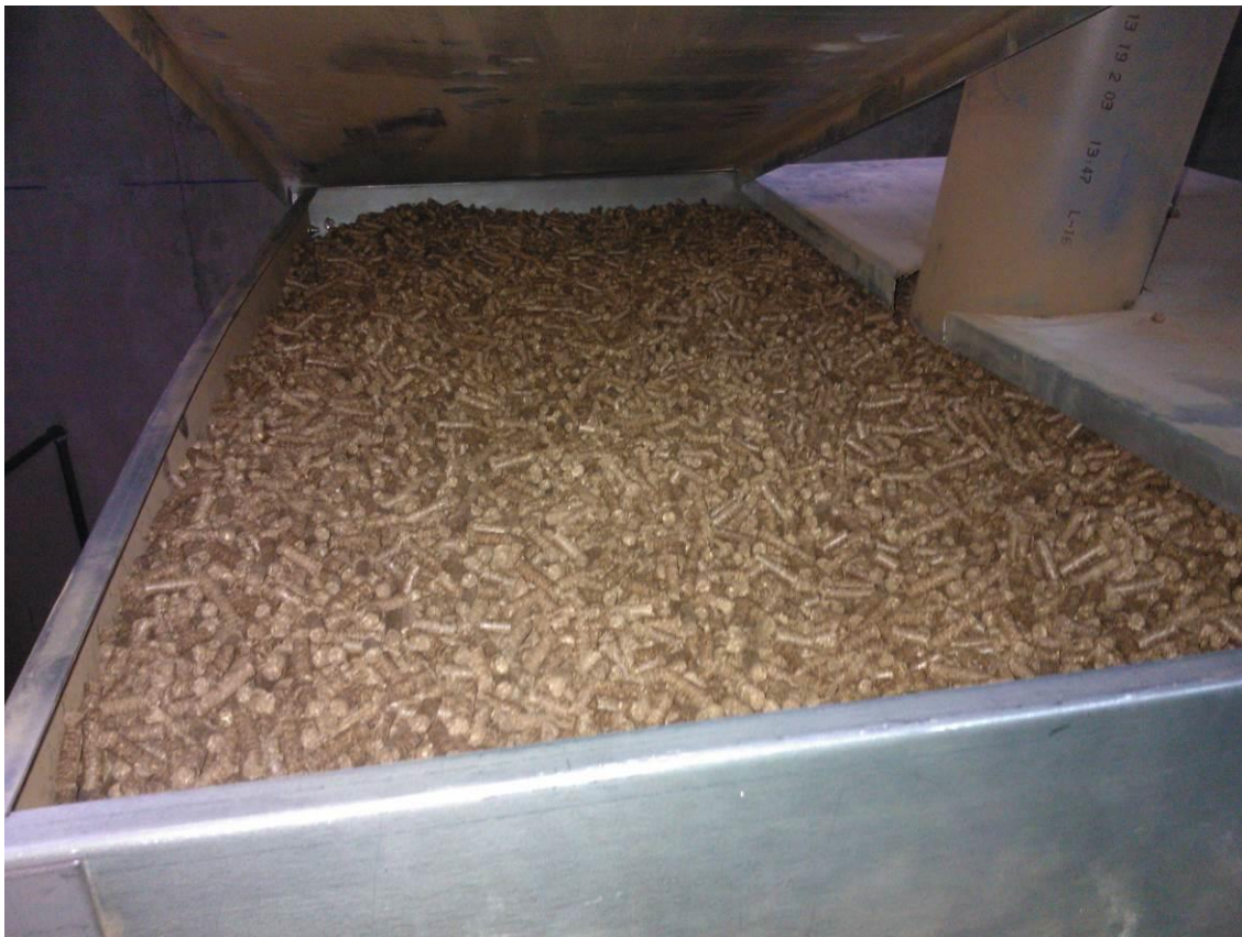
Fotografía 32. Pélet de origen forestal puesto en el silo de la caldera del edificio consistorial para su prueba.
