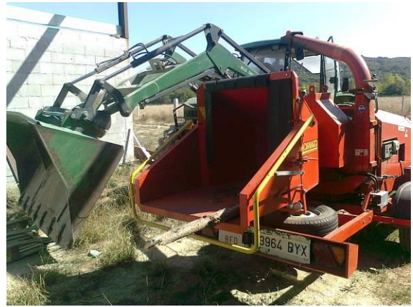
Fotografía 4. Trituradora forestal CARAVAGGI CIPPO 25 con motor IVECO 60HP adquirida.
