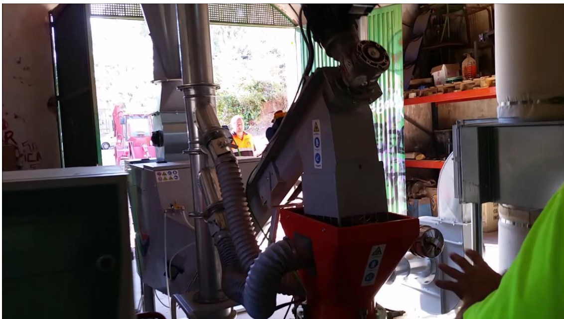
Fotografía 22. Puesta en marcha de la línea semi industrial de peletizado.
