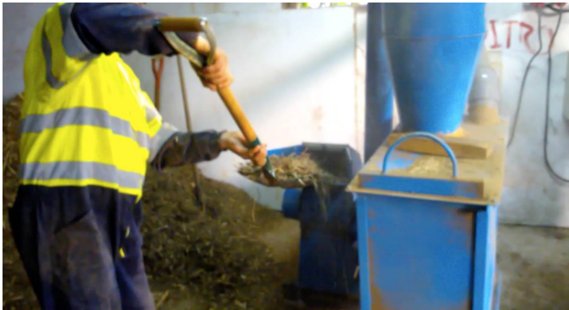
Fotografía 10. Alimentación manual del molino de martillos.
