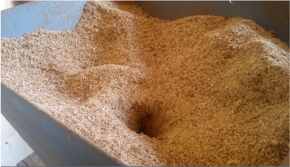
Fotografía 12. Tolva acoplada a la peletizadora de 15 kW en funcionamiento.
