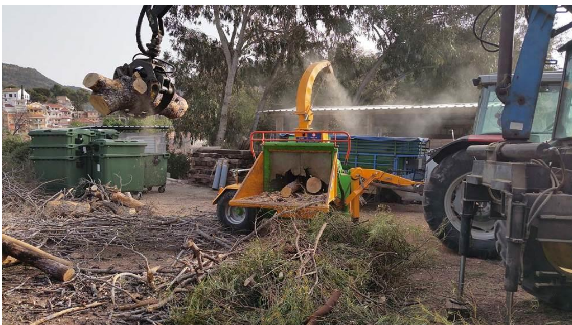
Fotografía 30. Triturado del residuo forestal en planta.
