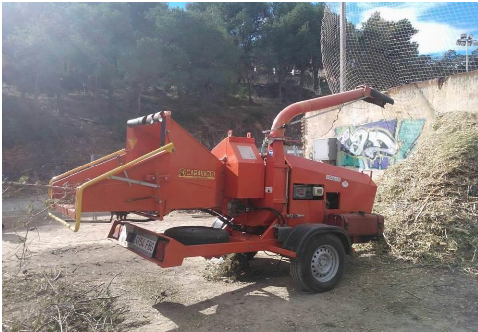
Fotografía 6. Trituradora forestal en funcionamiento.
