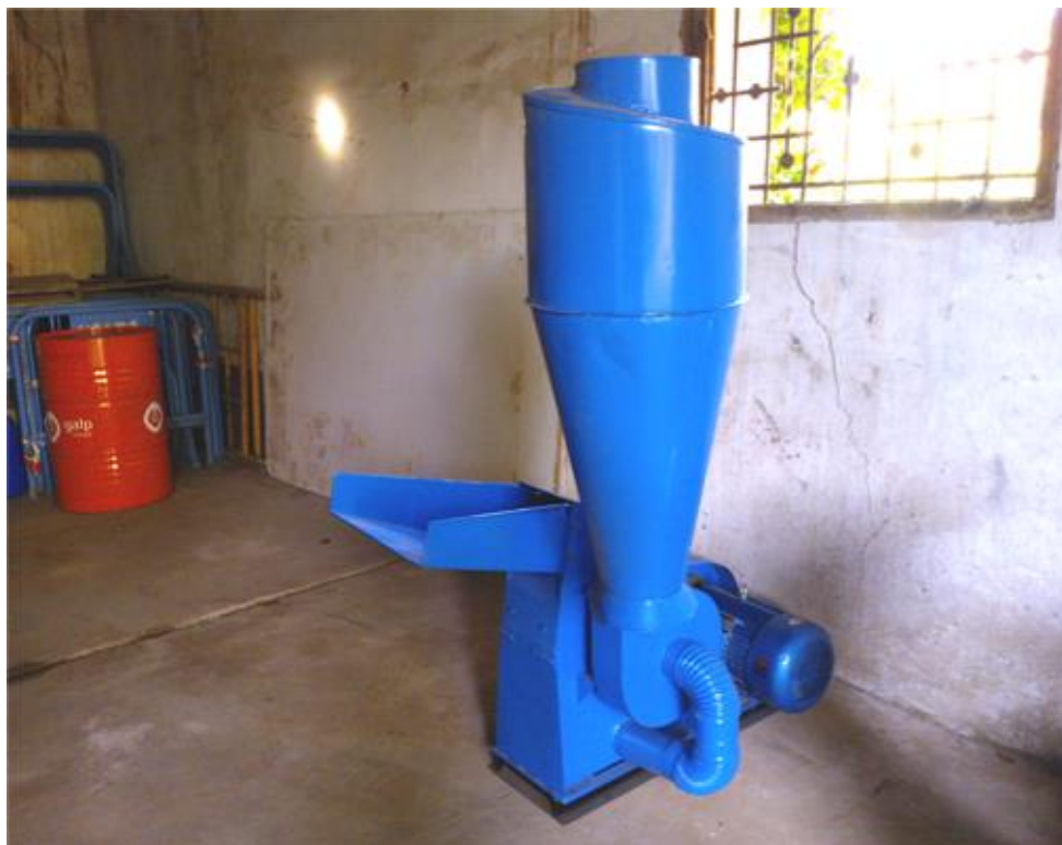
Fotografía 7. Molino de martillos de 7,5 kW con ciclón para partículas finas. Fuente: Elaboración propia
