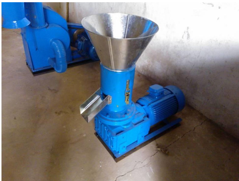
Fotografía 8. Peletizadora de 7,5 kW. Fuente: Elaboración propia
