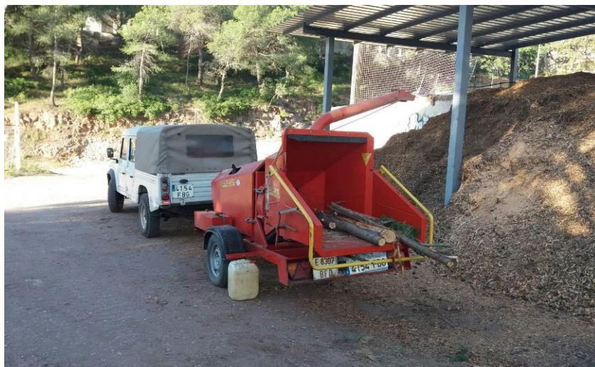
Fotografía 5. Trituradora forestal enganchada al vehículo de la brigada municipal.
