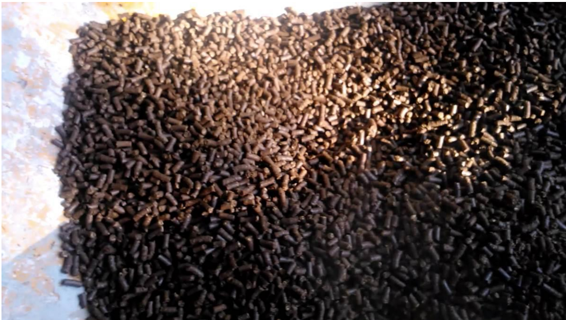
Fotografía 29. Pélet enfriado obtenido al inicio del proyecto empleando la primera peletizadora de 7,5 kW. Fuente: Elaboración propia
