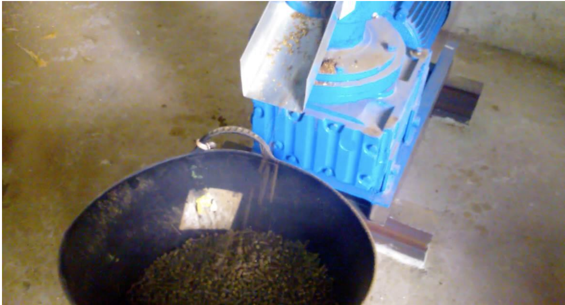
Fotografía 9. Peletizadora de 7,5 kW en funcionamiento.
