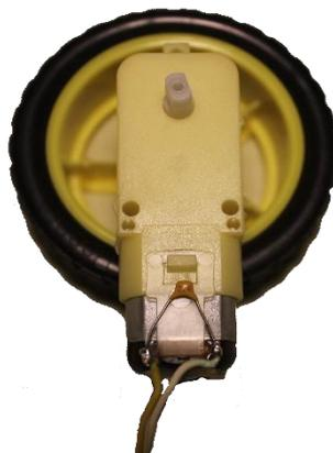
Ilustración 8 - Rueda con motor de 5V.
