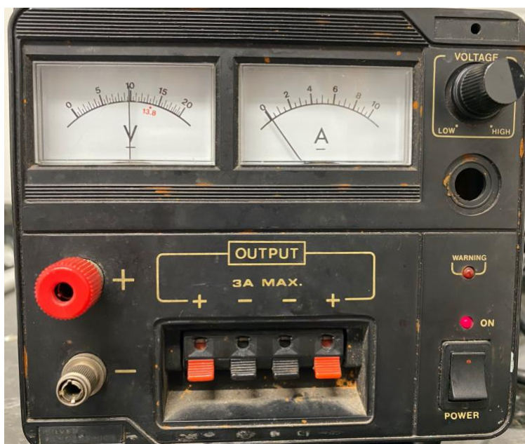
Figura 18: Variador de la tensión ajustado en 10 V
