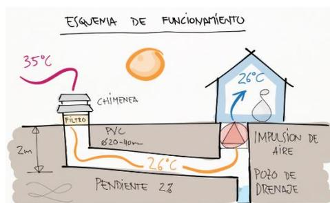
Fig. 36 \_ Esquema del funcionamiento de los pozos
