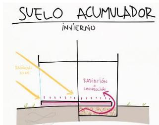
Fig. 34 \_ Dibujo de un suelo acumulador
