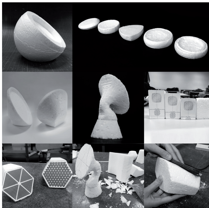
Fig. 2 Modelos de exploración formal en espuma. Proyecto de altavoz bluetooth en "Taller de modelos y prototipos". Formal exploration models in foam. Bluetooth Speaker project in "Model and Prototype Workshop" Fuente/Source: Conejero A., 2018. https://issuu.com/etsid/docs/3d_printed_speaker_design .
