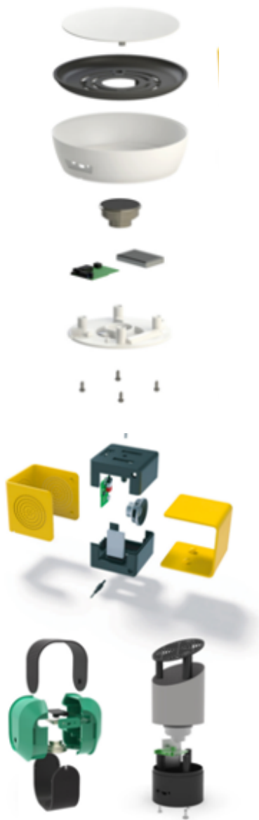
Fig.3 Modelos CAD correspondientes al proyecto de altavoz bluetooth realizados en la asignatura "Taller de modelos y prototipos". CAD models of the Bluetooth Speaker project developed in the subject "Model and Prototype Workshop". Fuente/Source: Conejero A., 2018. https://issuu.com/etsid/docs/3d_printed_speaker_design .
