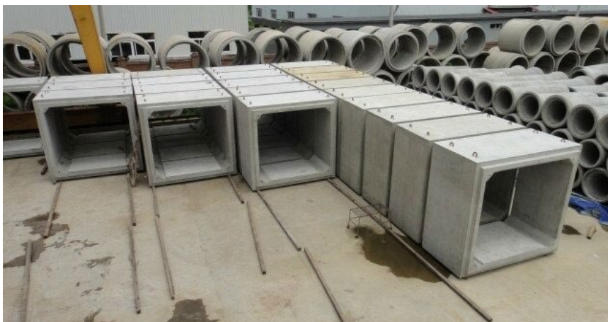
Imagen 86 Alcantarillas tipo cajón. (Fuente: https://hopreconsrl.com/ )
