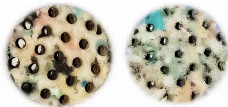
**Figura 6.3.** Espuma perforada con láser (izquierda) y fresadora (derecha) con las mismas especificaciones:  $D = 6 \text{ mm}$  y  $\phi_M = 20\%$ .
