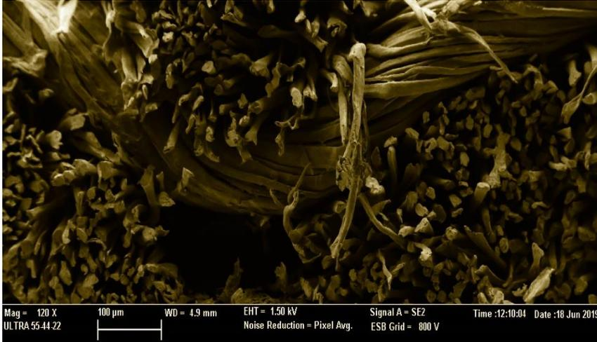
Figura 7.4. Imagen de microscopía electrónica de la sección transversal de la fibra textil.
