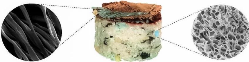
**Figura 6.7.** Muestra el sistema formado por la combinación tejido-espuma y detalle, a nivel microscópico, de los dos materiales.
