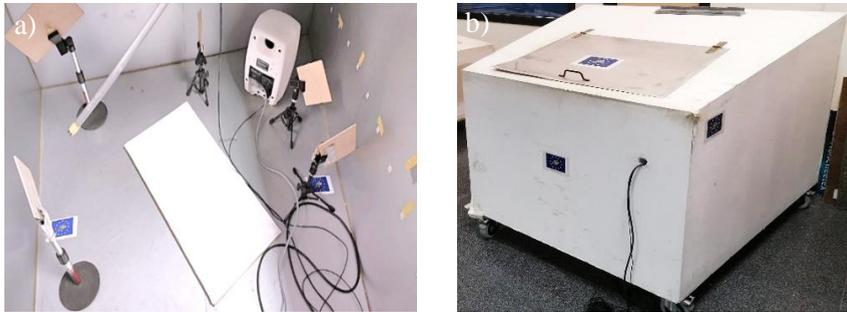
**Figura 3.5.** Detalle de la cámara reverberante de tamaño reducido. a) Interior de la cámara reverberante durante el ensayo de un material textil seleccionado. La fuente sonora se sitúa en las esquinas de la cámara reverberante a fin de excitar los modos de la sala; b) Exterior de la cámara reverberante.
