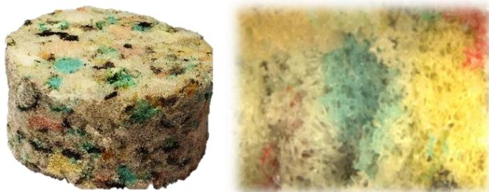
**Figura 6.1.** Espuma de poliuretano reciclada (RPU). A la izquierda se muestra un ejemplo de una muestra preparada para ensayo del coeficiente de absorción acústica en tubo de impedancia y a la derecha se observa la superficie de la muestra a través de microscopía con 16X aumentos.
