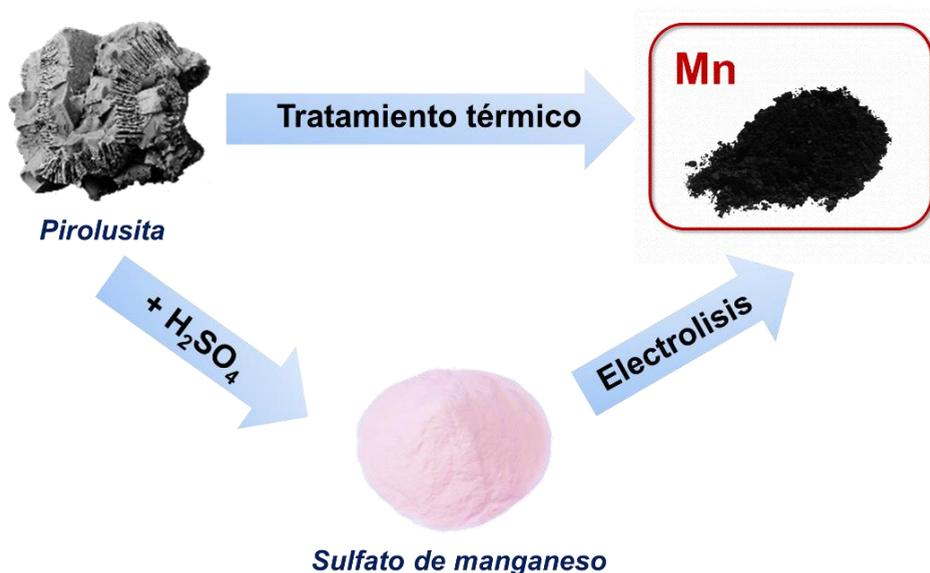
**Figura 4:** Esquema para la obtención de manganeso a través de la pirolusita
