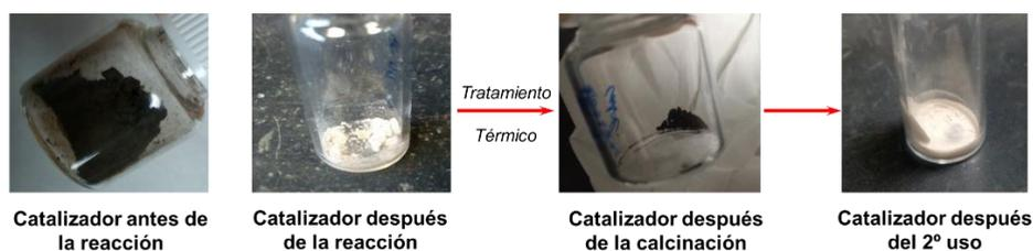
Tratamiento térmico:  $400^\circ\text{C}$ , 3h 15minutos, rampa de  $5^\circ\text{C}\cdot\text{min}^{-1}$ , aire
