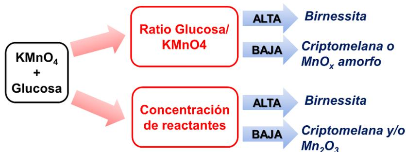
**Figura 8:** Esquema de síntesis a partir del método sol – gel, adaptado de la referencia [26].
