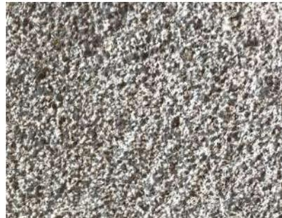
**Figura 18:** Gradina en ángulo recto con patrón (Trazando curva)
