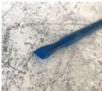
**Figura 20:** Detalle de un cincel plano (Del filo plano)
