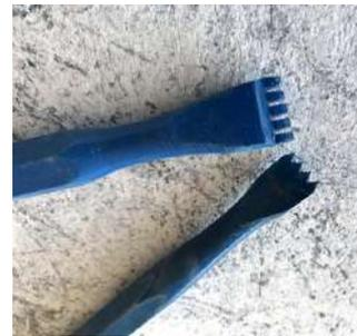
**Figura 14:** Detalle de una gradina con dientes planos
