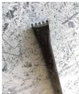
**Figura 13:** Detalle de una gradina de dientes en punta
