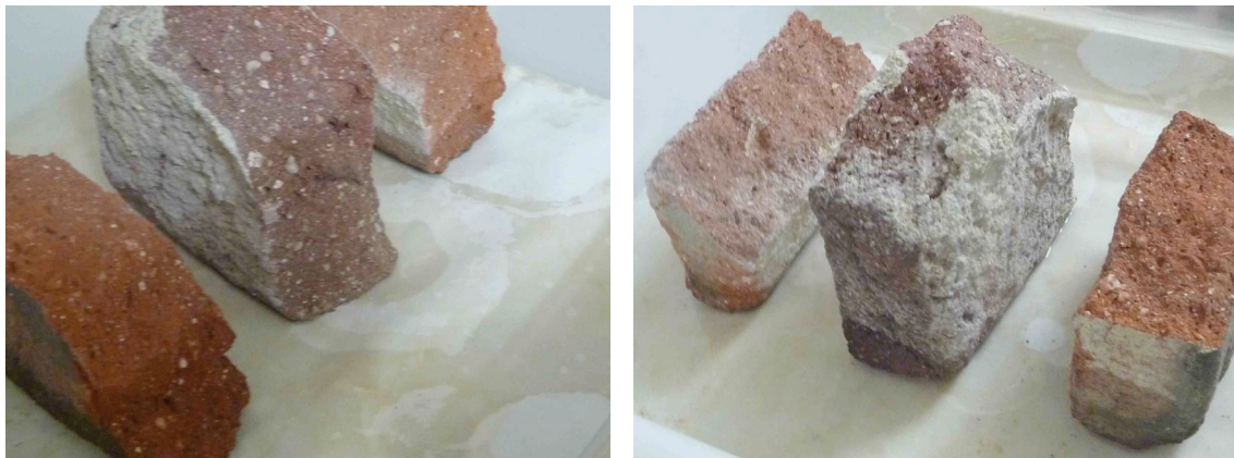
Ensayo de absorción de agua por capilaridad
