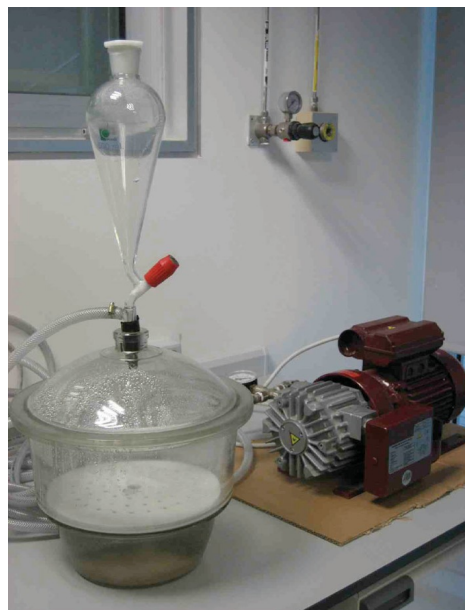
Ensayo para la determinación de la porosidad abierta
