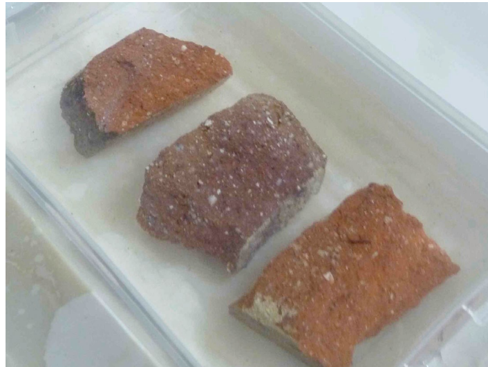
Ensayo de absorción de agua por inmersión total
