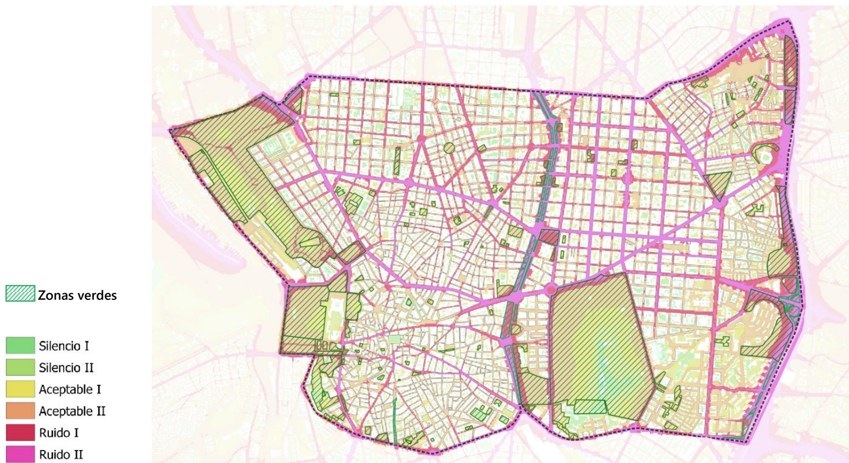
Imagen 51. Contaminación acústica y las zonas verdes del recinto objeto. Fuente: Elaboración propia.
