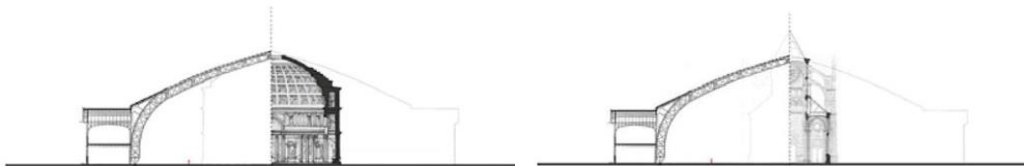
Figura 43: Comparación de la altura en sección entre la Galería de las Máquinas y el Pantheon de Roma de 128, y la Catedral de Amiens de 1220. (Linares de la Torre, 2018)
