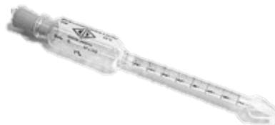
Figura 5. Butirómetro Gerber
