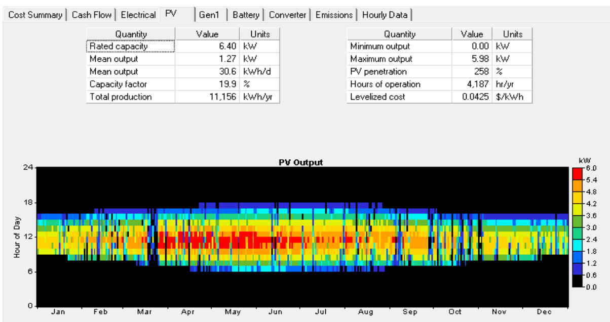
Ilustración 54. Resultados producción energía fotovoltaica en instalación aislada de la red
