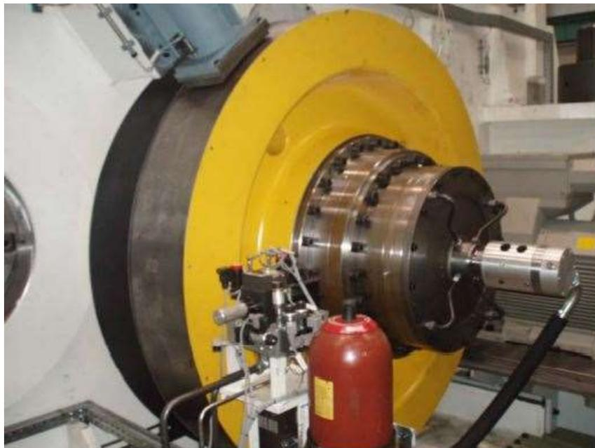
*Figura 3.2: Volante de inercia y embrague*
