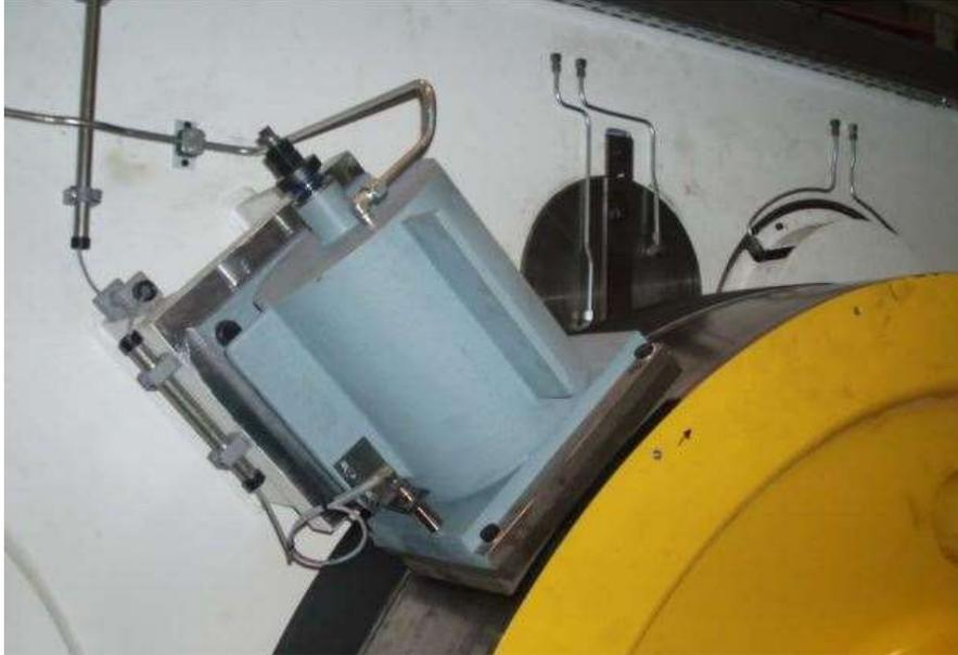
*Figura 3.3: Freno del volante de inercia*
