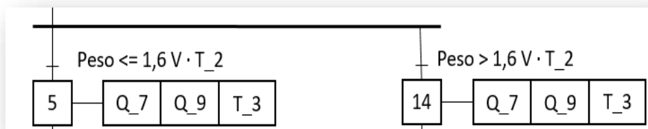
Figura 20. Divergencia en Y GRAFCET.
