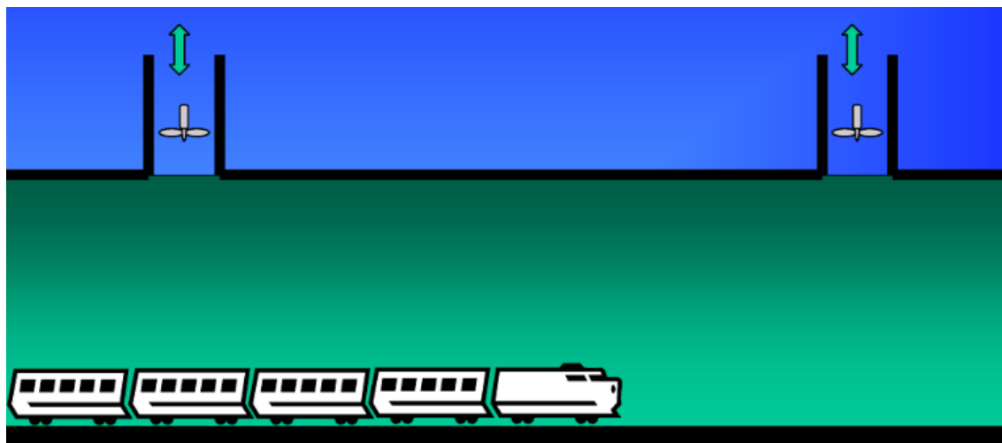
Ilustración 32. Ventilación mediante pozos. Fuente: Internet
