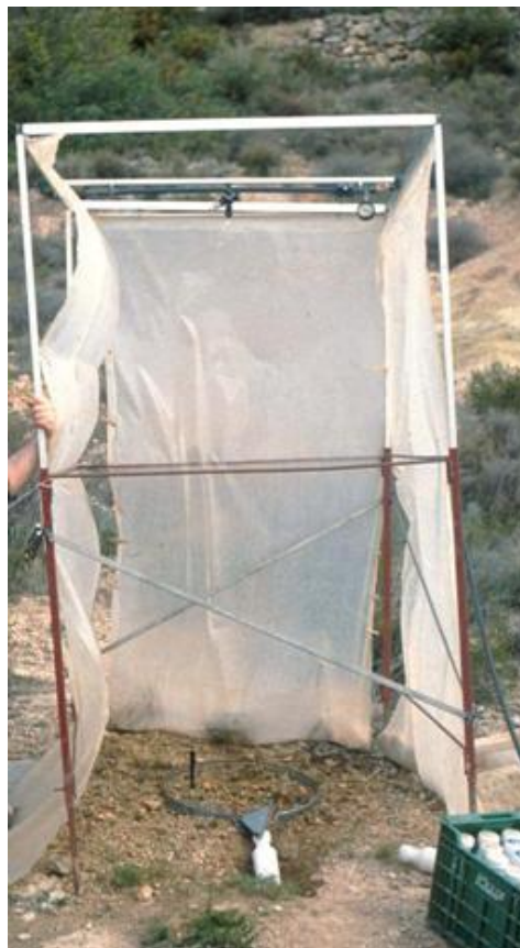
Figura 6: Aspecto general de un simulador de lluvia portátil
