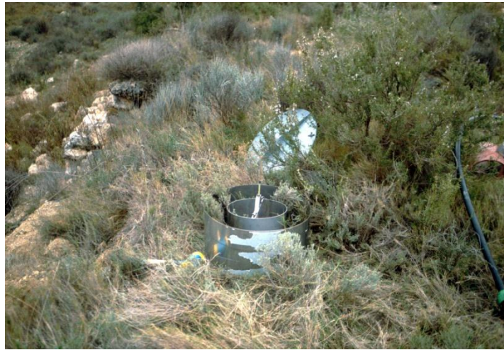
Figura 4: Anillos de infiltración
