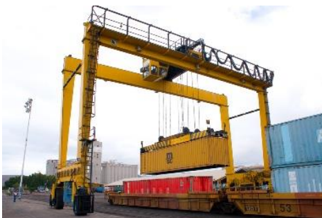
Imagen 1-3 Grúa RTG. (Fuente: ellenguaportico.es 18/04/21)
