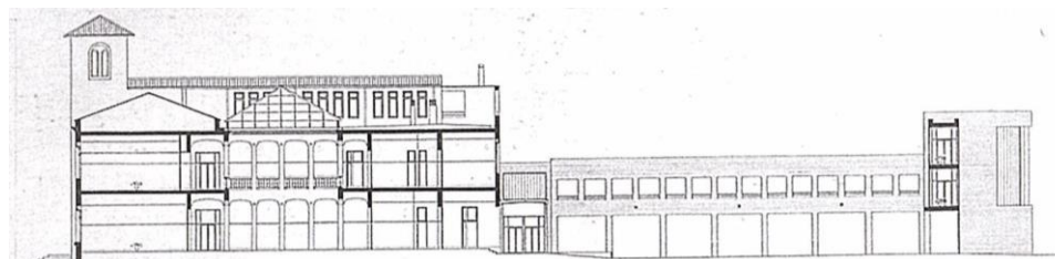
Fig. 52. Sección longitudinal por el eje central que pasa por la puerta principal y recorre todos los espacios comunes del conjunto. Fuente: IVAM
