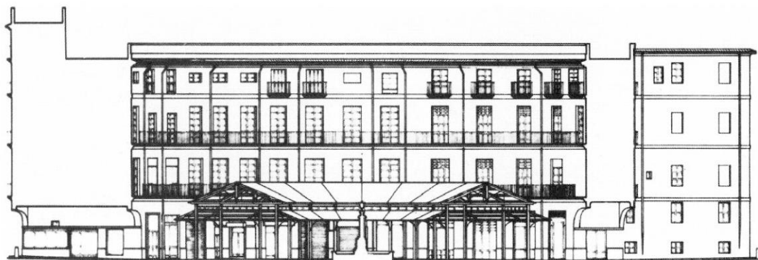
Fig. 81. Sección de la Plaza Redonda por los accesos desde la Calle de la Pescadería y la Plaza Lope de Vega, donde se secciona también la antigua cubierta realizada en madera, dibujada por un estudiante de la ETSAV en el año 1981. Fuente: L'Espill.
