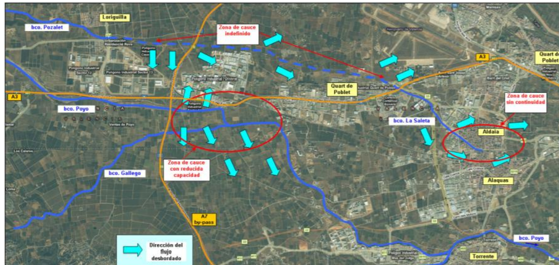
Figura 6. Comportamiento hidráulico de los barrancos Pozalet-Salet. Fuente: F. Franch et al., 2010
