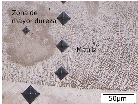
Figura 5.19 Barrido de microdureza en el cordón 13 (500W y 12 mm/s) para 40 % de TiB_2 sobre Ti
