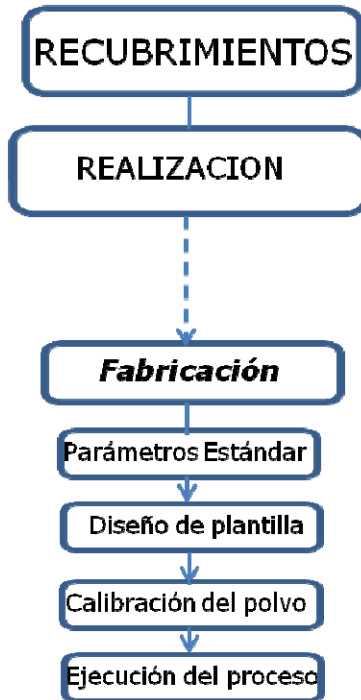
Figura 3.9 Detalle del Diagrama de flujo de la Fase III. Fabricación.
