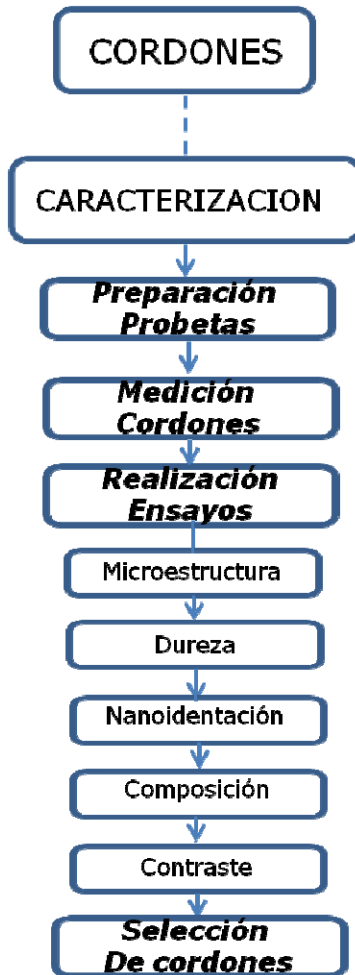
Figura 3.7 Detalle del Diagrama de flujo de la Fase II. Caracterización.
