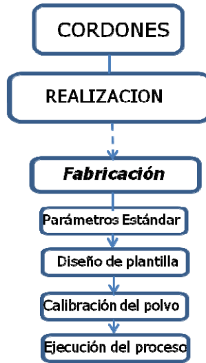
Figura 3.5 Detalle del Diagrama de flujo de la Fase II. Fabricación.
