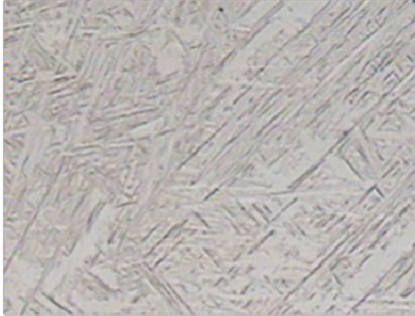
Figura 2.4 Martensita en Ti6Al4V luego de un proceso láser.
