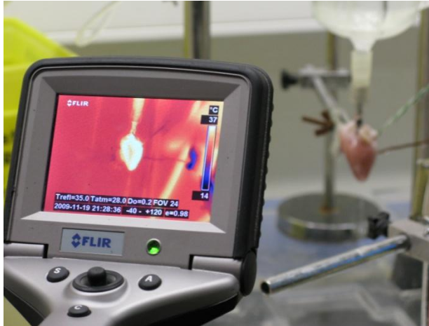
Figura 3.8 Registro de la temperatura epicárdica de la preparación experimental mediante una cámara de infrarrojos
