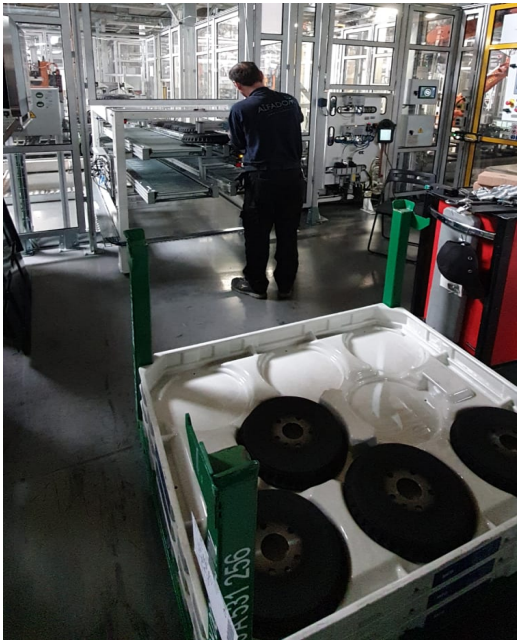
Figura 1 Operario realizando carga manual de discos en la planta de Volkswagen en Braunschweig. Elaboración propia.
